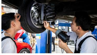
Os componentes do sistema de suspensão devem ser inspecionados periodicamente, conforme as manutenções indicadas pelo manual do proprietário ou quando houver alguma percepção de irregularidade no sistema, como barulho, desconforto ao dirigir e instabilidade do veículo.
